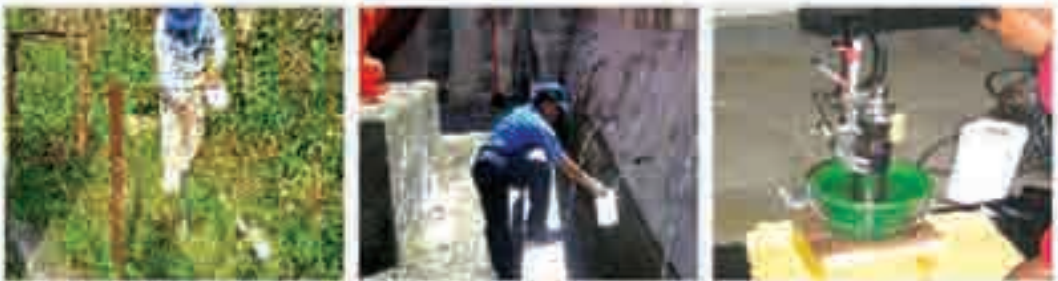
Gambar pengambilan sampel dan deteksi pasca injeksi radioisotop dalam penelitian kebocoran waduk/dam
