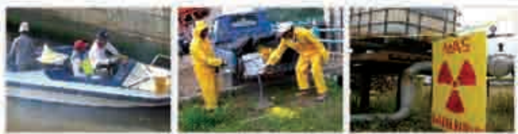
Gambar injeksi isotop buatan dalam rangka penelitian kebocoran waduk/dam
